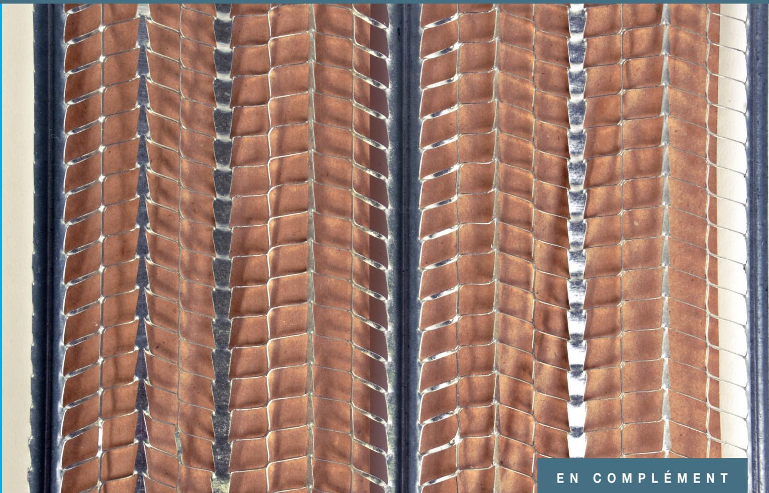
Le GRIFF LATT® doublé papier kraft sert de support d'accroche en murs et en plafonds, en utilisation intérieure (conforme à la norme NF EN 13658-1). Le papier permet à la fois de ne pas gâcher de produit, mais aussi de maintenir une lame d'air entre le GRIFF LATT et le support quand cela est nécessaire.
