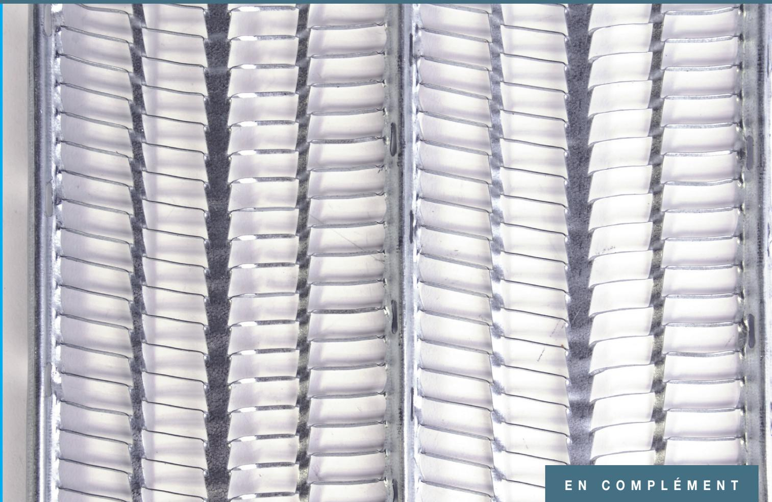
L'Acier Déployé Schultz® nu (sans doublage papier) sert de support d'accroche en murs et en plafonds, en utilisation intérieure (conforme à la norme NF EN 13658-1) ou extérieure (conforme à la norme NF EN 13658-2). Ses mailles larges (20 mm au lieu de 10 mm) facilitent le passage des produits épais.
